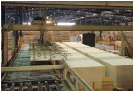
Aufstapelung der SWISS KRONO LONGBOARD OSB mittels Saug-Traverse im Werk in Heiligengrabe (Bildnachweis: SWISS KRONO GmbH | www.rosengruen.de )
