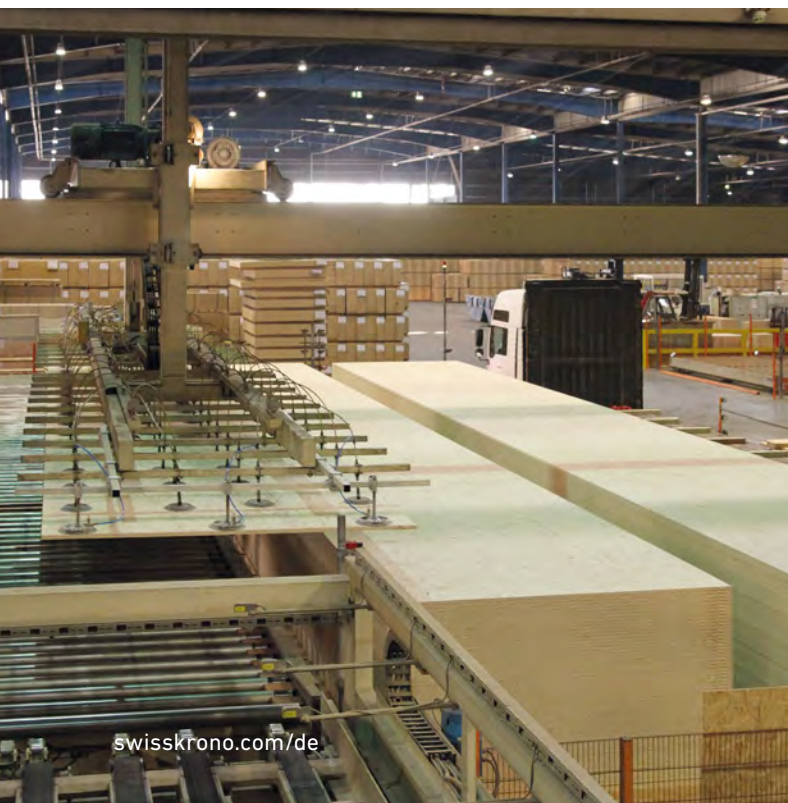
Abstapelung der SWISS KRONO LONGBOARD OSB mittels Saug-Traverse
